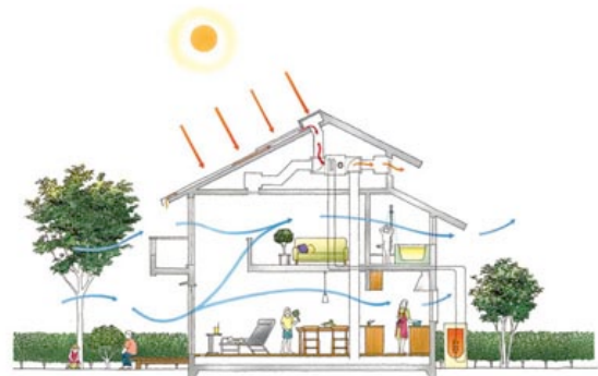
図2 OMソーラシステムの夏の動作
