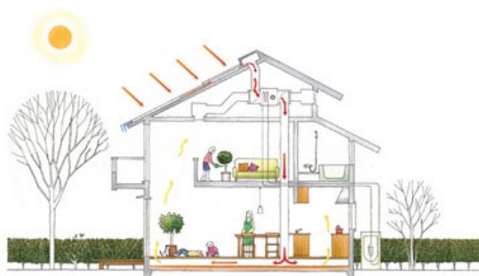
図1 OMソーラシステムの冬の動作
